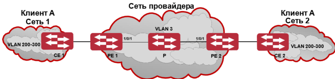
Рисунок 13.1 – Межсетевое взаимодействие на основе Dot1q-туннеля
